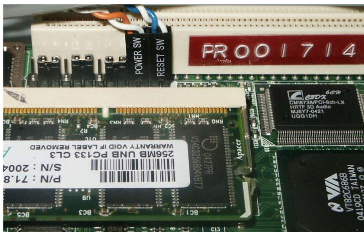
Les connexions des switch power et reset sont essentiel, rien ne peut arriver sans eux. La photographie sur la gauche montre les connexions sur la carte-mère, toutefois le câble venant des connecteurs différents selon les boîtiers. Les pins des connecteurs doivent être connectés toujours de la même façon.
